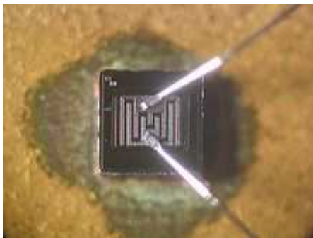
Abb. 4: Nahaufnahme eines Halbleiterplättchens (engl. die) mit einem Bipolartransistor von oben und den Anschlussdrähten. [5]
